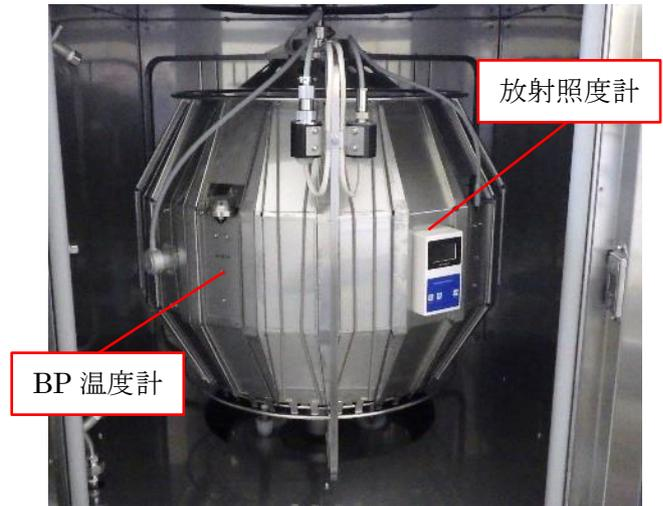
写真4 定期点検時の槽内の様子
