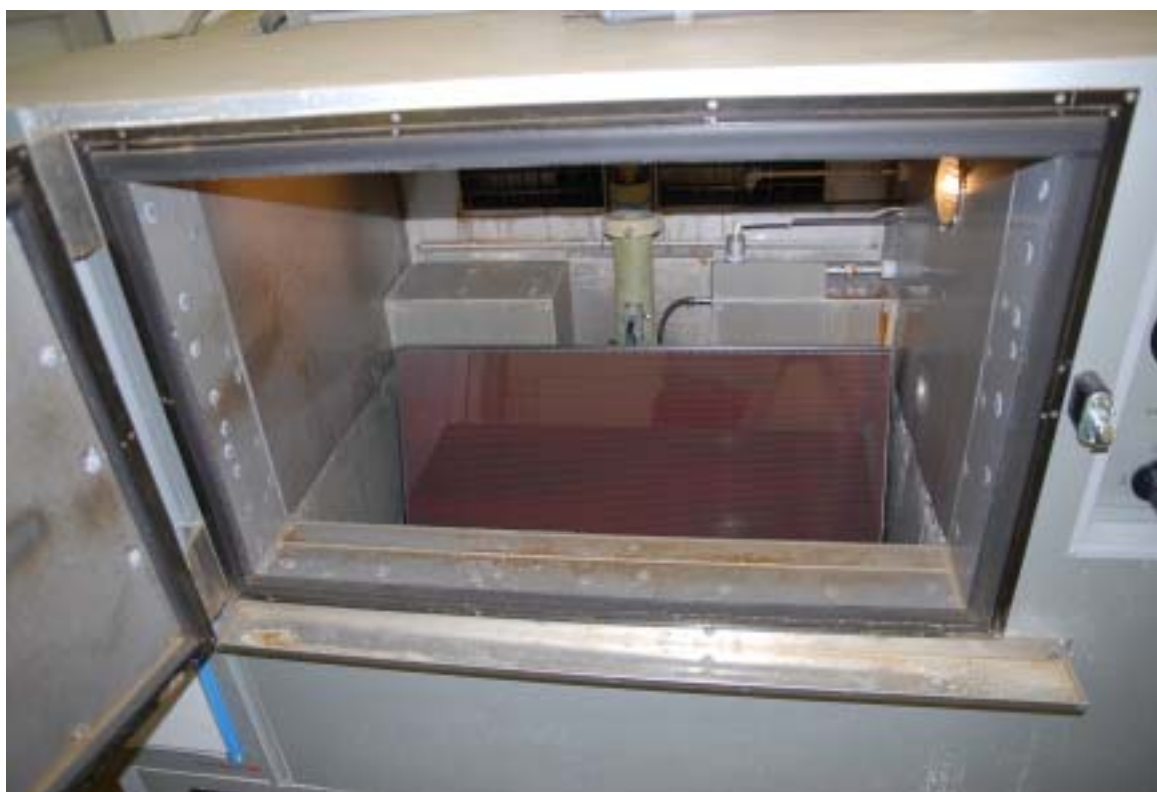
図 5-3 複合サイクル試験前の試験体設置状態
