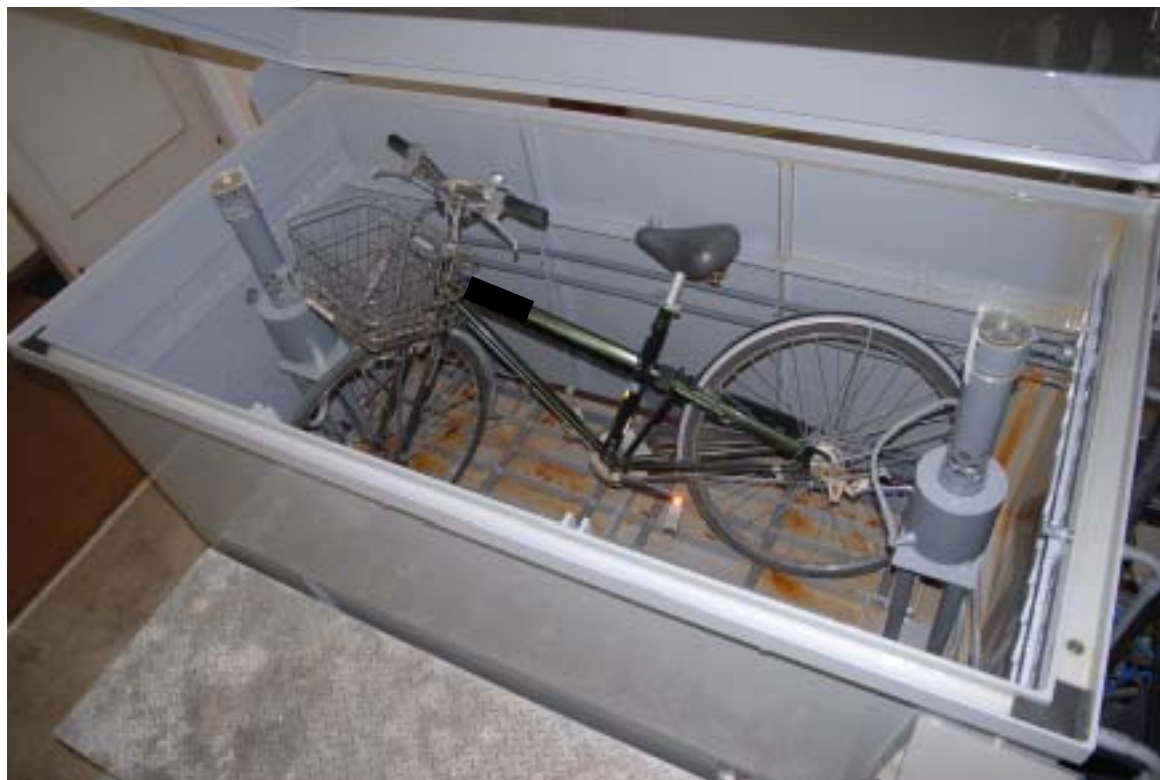
図 5-2 連続塩水噴霧試験前の試験体設置状態
