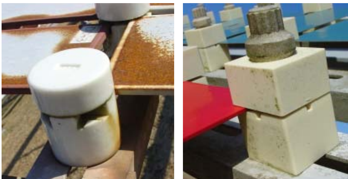
写真2 試料保持具(左：磁器製、右：プラスチック製)
